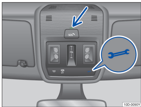
图 36 在顶篷中控台内：eCall 紧急呼叫系统的操作元件（后方的按钮盖）
