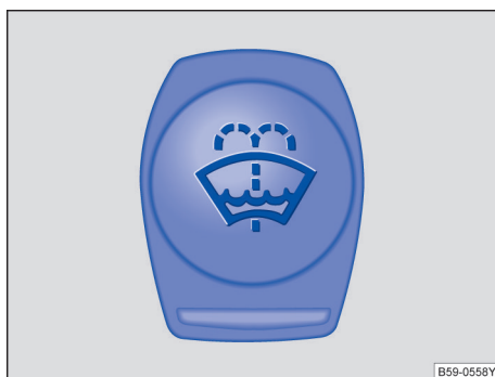
图 136 前舱内：风窗清洗液容器盖
