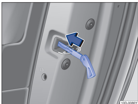
图 47 车门应急上锁装置及汽车钥匙
