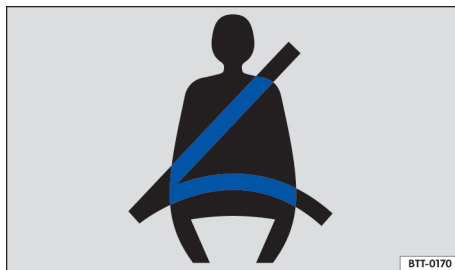
图 17 安全带未系警告灯
