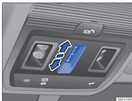
图 78 在顶篷中：打开或关闭遮阳卷帘
