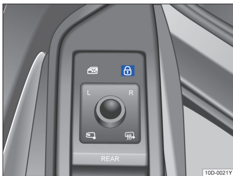
图 44 驾驶员侧车门内：中央门锁按钮
