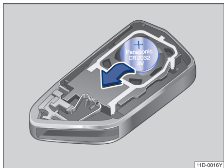
图 41 汽车钥匙：更换纽扣电池
