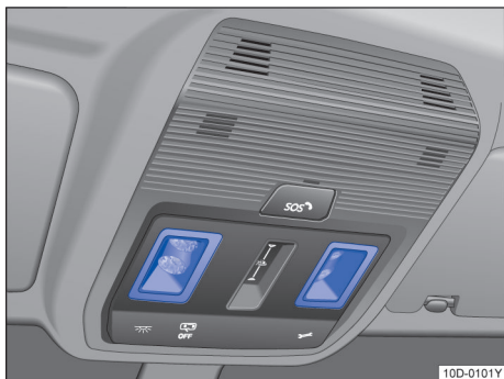
图 71 顶篷中控台：触摸感应式阅读灯
