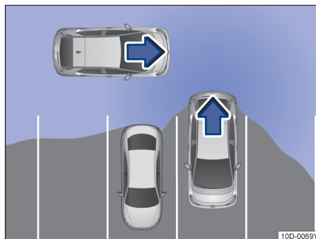
图 103 驶出车位辅助示意图：车辆驶出停车位时的四周监控范围
