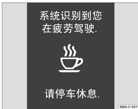
图 85 组合仪表显示屏：疲劳警示符号
